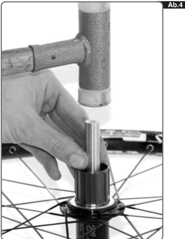
Die Nabe wird auf das Basiswerkzeug **TT08.1** gelegt und die Achse zur linken Seite hin (Scheibenbremsseite) aus der Nabe herausschlagen. Dazu wird das Werkzeug **TT08.2** mit dem Adapter **TT08.3** verwendet. **Ab.3 & 4**
