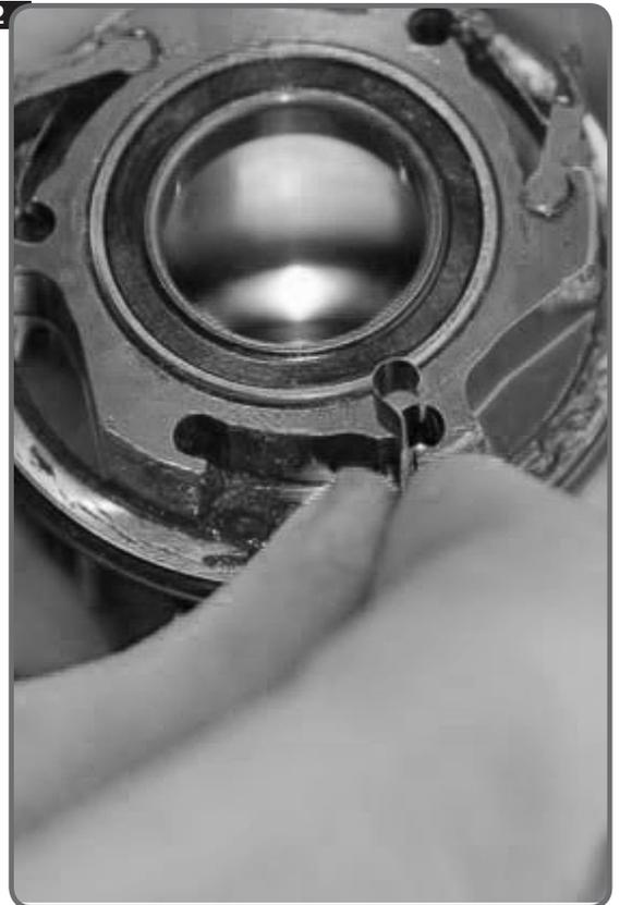
Nun muss der Überstand der Achse gemessen werden. Dazu mit dem Tiefenmaß des Messschiebers das frei überstehende Achsende der Nabe ab dem Innenring des Kugellagers gemessen werden. Hier muss sehr präzise gemessen werden, am besten ist es die Messung mehrfach zu wiederholen.
