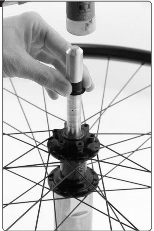
Die Achse wird an den Kontaktstellen mit Fett ① eingepinselt. **Ab.10**
