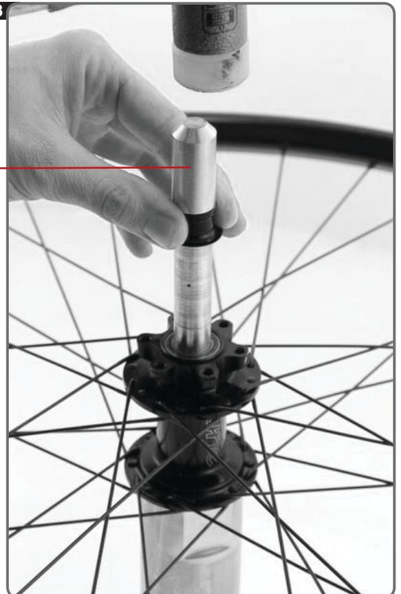
Alles zusammen wird auf das Basiswerkzeug TT08.1 gesetzt. Mit dem Werkzeug TT08.5 und dem Kunststoffhammer wird die Achse in die Nabe zurückgeschlagen.
