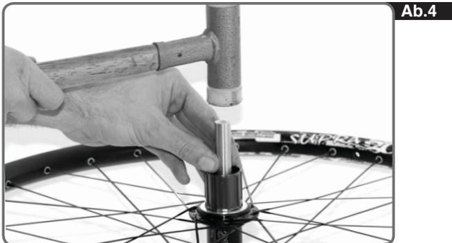
Die Nabe wird auf das Basiswerkzeug **TT08.1** gelegt und die Achse zur linken Seite hin (Freilaufgegenseite/Scheibenbremsseite) aus der Nabe herausschlagen.
