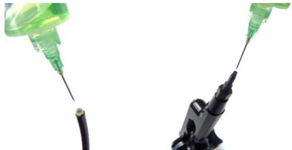
6. Stecken Sie die Überwurfmutter auf die Leitung und schrauben Sie den Fitting wieder in die Leitung, ohne dass Luft in das System gelangt. Dabei quillt etwas Flüssigkeit über, die Sie mit einem Tuch aufnehmen.
