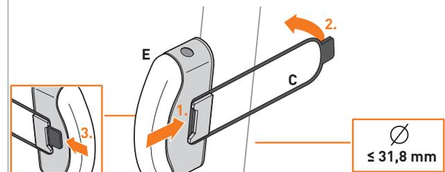
**04 DE** Rücklicht (E) mit Hilfe der Schlaufen vom Gummiband (B) an den Gepäckträger montieren. **Hinweis.** Achten Sie auf den korrekten Sitz des Gummibandes.
