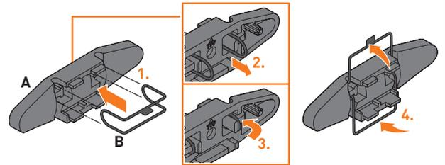
**02 DE** Rücklichthalterung (A) auf den montierten Gepäckträger setzen. Die Bolzen der Halterung (A) müssen in die Bohrungen des Gepäckträgers greifen. **Hinweis.** Ausrichtung beachten.
