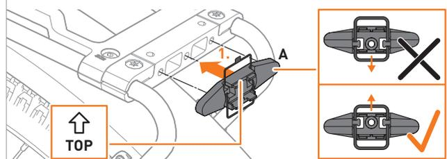
**03 DE** Rücklichthalterung (A) mit Schraube (D) an Gepäckträger fixieren.
