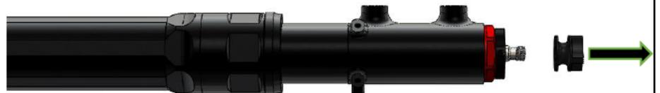
9. Finalmente, con ayuda de la herramienta Torque Key incluida en el kit, accionar el dial girándolo en sentido anti horario para regular la compresión según gusto o necesidad del usuario. Con esta regulación se varía el volumen interior de la cámara de aire, lo que permite un ajuste fino e ilimitado de la fuerza necesaria para hundir la suspensión.
