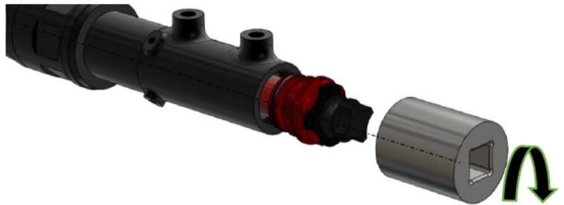
8. Retirar el tapón de la válvula e introducir aire con ayuda de una bomba hasta alcanzar la presión especificada por la marca (entre 56-147 Psi). Volver a colocar el tapón.
