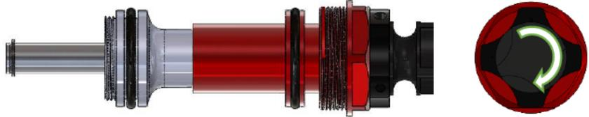
5. Lubricar O-rings y zonas coloreadas en morado con grasa especial para componentes de horquillas.
