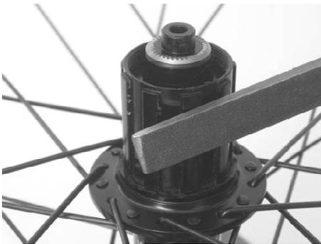
4. Mit Feile die Einkerbungen im Aluminiumrotor grob entfernen.
