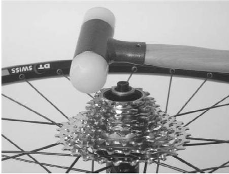
2. Mit Kunststoffhammer die Zahnkränze gegen Uhrzeigersinn leicht lösen.
