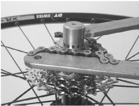
1. Lockring mit Zahnkranzabnehmer lösen.
