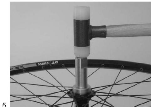
4. Das Montagewerkzeug für die Rotordichtung mit der vormontierten Dichtung auf die Achse schieben.
