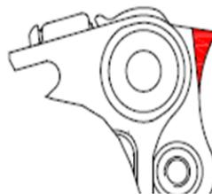
Figura 23: posizione corretta dei link per inserire la leva
