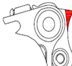
Figura 17: posizione corretta dei link per inserire la leva
