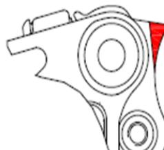
Figura 26: posizione corretta dei link per inserire la leva
