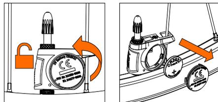
Setzen Sie eine neue CR2032 Batterie mit der Plusseite Richtung Batterieabdeckung in das Sensorgehäuse ein, montieren Sie die Batterieabdeckung und verdrehen Sie diese im Uhrzeigersinn bis die Markierungen übereinstimmen.
