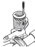
11. Ändern Sie den Hebelwinkel zwei Mal und führen Sie Schritt 10 für jeden Winkel durch.
