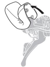
2. Entfernen Sie die Entlüftungsschraube und den O-Ring und befestigen Sie den Öltrichter.
